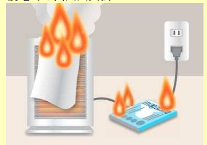
復電時の出火火災例
